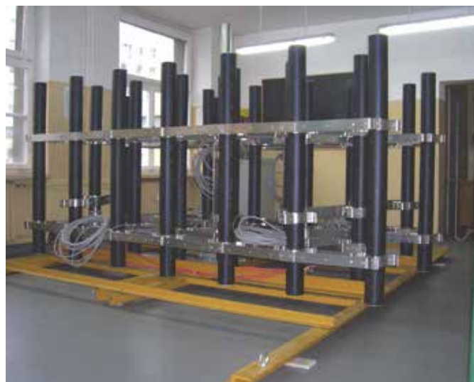
Prototyp tłumika fal według patentu PAT. 210447 Źródło: archiwum Akademii Morskiej w Szczecinie
