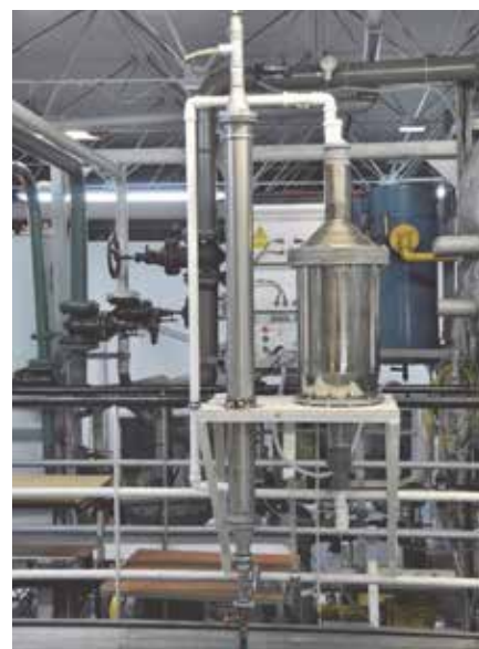
Opracowana w trakcie realizacji projektu ENVISUM badawcza, eksperymentalna instalacja oczyszczania spalin z silnika okrętowego zainstalowanego w Laboratorium Siłowni Okrętowych Instytutu Eksploatacji Siłowni Okrętowych Akademii Morskiej w Szczecinie Źródło: archiwum Akademii Morskiej w Szczecinie
