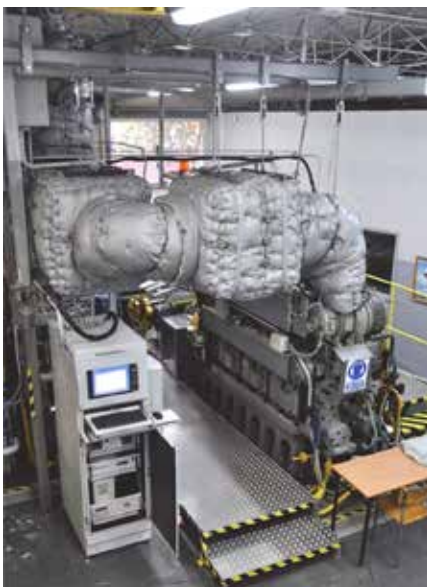
Opracowana w trakcie realizacji projektu ENVISUM badawcza, eksperymentalna instalacja oczyszczania spalin z silnika okrętowego zainstalowanego w Laboratorium Siłowni Okrętowych Instytutu Eksploatacji Siłowni Okrętowych Akademii Morskiej w Szczecinie Źródło: archiwum Akademii Morskiej w Szczecinie
